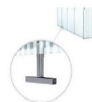
T formos kojelės tvirtinimo schema
